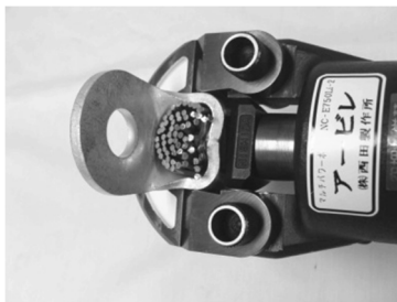
パワーユニットを操作し圧力規制弁が働くまで加圧する
