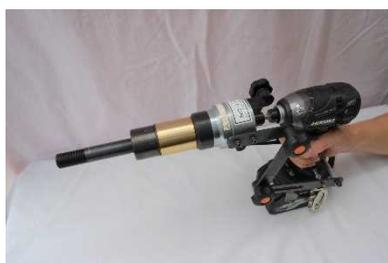
3. アーム 2 の押さえバーがインパクトドライバのハンドル部分の外側下 (バッテリーに近い側) に当たった状態で固定ノブを固定してください。左右位置決めストoppaがインパクトドライバのグリップの両側面にあたるように調整し、ナットでしっかりと固定してください。
