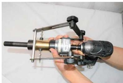
2. ビットを確実に取り付けたらアーム2をインパクトドライバの後ろ側に回して下さい。（注 アームを装着する際は、指を挟まないように十分に注意して作業を行なってください。）
