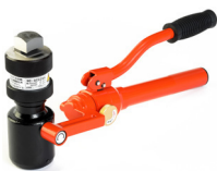
セット完了（油圧フリーパンチ）
